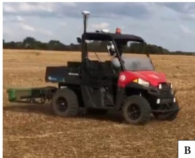
Figura 2. Sistema utilizado para determinar a condutividade elétrica aparente no solo: contato direto (A) e por indução eletromagnética (B).
