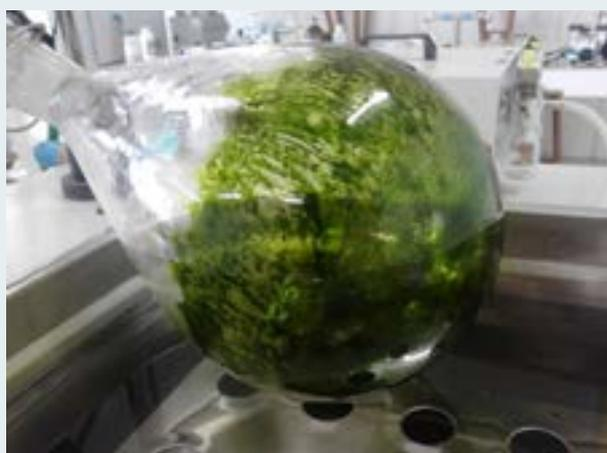
**Figura 2** — Evaporador rotativo (marca: Solab®) a uma temperatura de  $55 \pm 2^\circ\text{C}$  para a extração de extratos alcoólicos.
